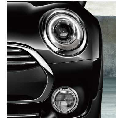
LED ヘッドライト/ LED デイライト・リング LED フロント・フォグ・ランプ
